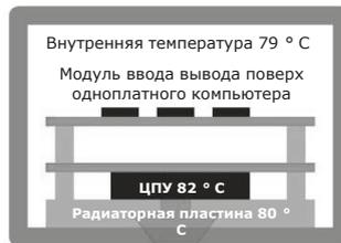
Температура ЦПУ существенно ниже при кондуктивном охлаждении чем при использовании радиатора. Она может быть снижена на 20 °C или более.
